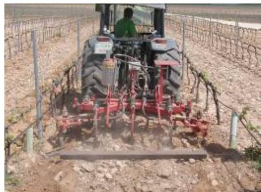
Figura 24. Cultivador extensible con doble intercepas mecánico
